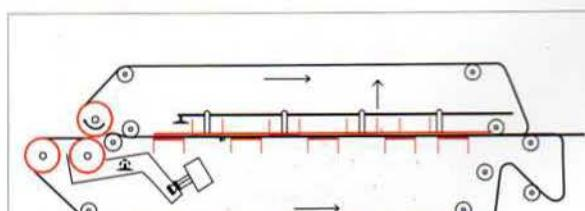
ヒートカムは上部ヒーター板の高さを調整します。
